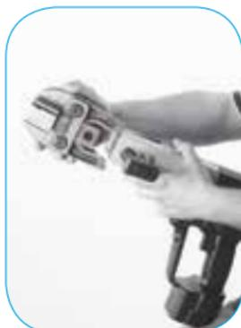
Setzen Sie die Pressbacke in das Gehäuse.
