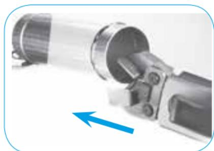
Öffnen Sie die 2 Pressbacken manuell. Legen Sie das Aluminiumrohr soweit wie möglich in die Presse ein.
