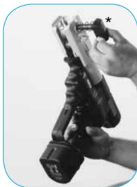
Öffnen Sie den Verriegelungsbolzen vorne an der Maschine, indem Sie den \* Knopf drücken.
