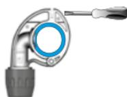
4. Ziehen Sie die Schraubenmutter mit einem Inbusschlüssel Hex 5 mm oder Hex 3/16" fest. Torque: 5-10 N.m
