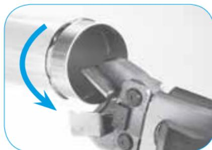
Öffnen Sie die beiden Pressbacken und entnehmen Sie das Rohr. Drehen Sie das Rohr leicht.
