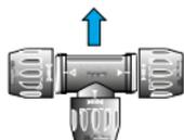
**4.** Setzen Sie die Mutter des T-Anschlusses ein. Setzen Sie das T-Mittelteil so zwischen den 2 Rohren ein, dass sich die leeren und gefüllten Pfeile gegenüber stehen.
