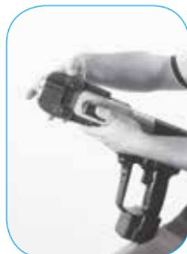
Verriegeln Sie die Pressbacke durch Schließen des Verriegelungsbolzens.
